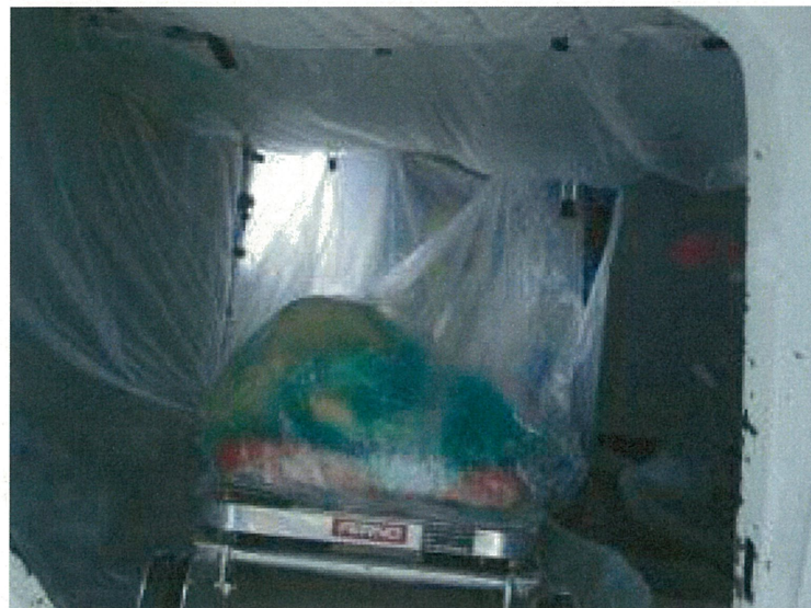
写真④ ヘリコプター内壁の防護状態と、ストレッチャー上の患者が天幕よりのビニールにより2重に被覆されている状態
